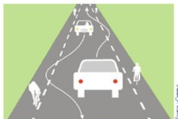
Principe de fonctionnement d'une CVCB
