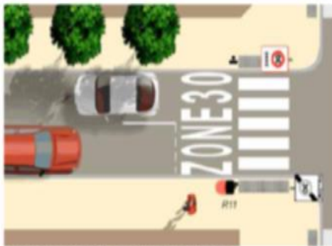
Signalisation d'entrée de zone 30 complétée par un marquage accolé au passage piéton
